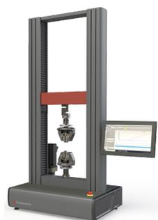
Machine d'essai universelle
