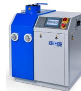
Machine d'essai d'emboutissage
